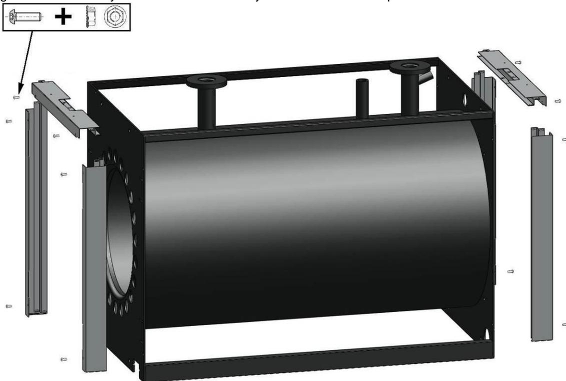
NOTA: La pieza transversal indicada en la figura, si se incluye en el embalaje, va posicionada entre los dos tubos cuadrados para apoyar los listones.
