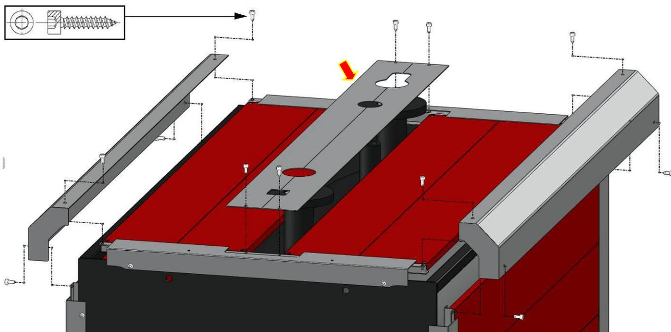
NOTA: En el caso de calderas con montaje superior, deberán montarse las mascarás centrales especiales, señaladas en la figura.
